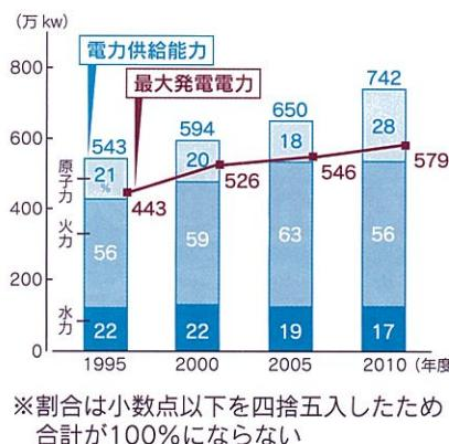
北電の電力供給能力は742万kw。泊原発1～3号機(207万kw)をすべて停止すると供給能力は535万kw。最大発電力が579万kw(2011年1月)であることから、泊原発の発電を止めると約40万kwの電力が不足します。
