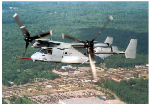
MV-22オスプレイ。離着陸時はプロペラを上、航行時は前にむけます。(写真はウィキペディア・コモンズより)
